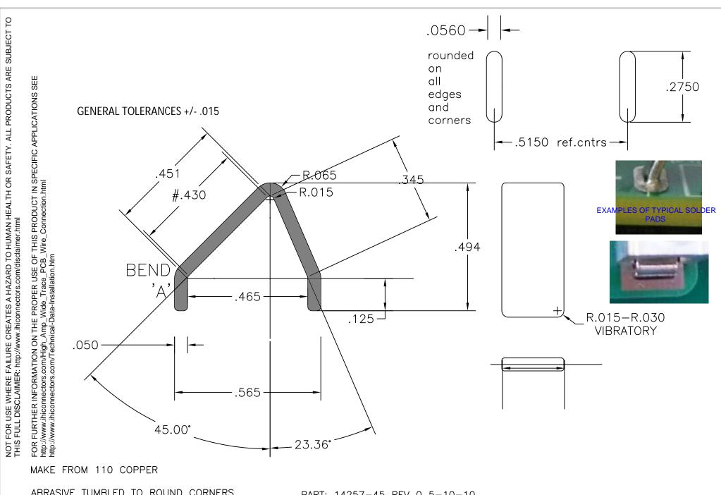
ABRASIVE TUMBLED TO ROUND CORNERS TIN PLATE FOR SOLDERABILTY
